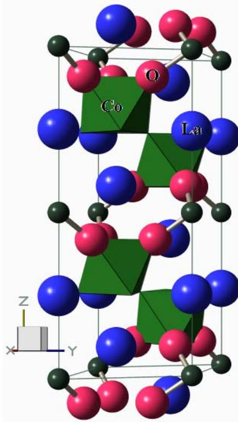
**Figure 2.**  $\text{LaCoO}_3$  structure ( $R\bar{3}c$ ).
