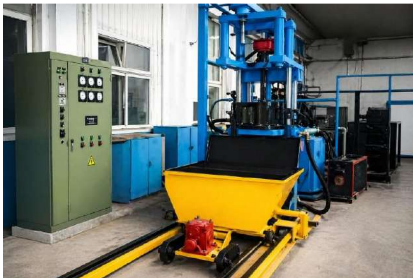
Рис. 1. Установка ТВЧ для обработки внутренней поверхности цилиндрической втулки бурового насоса.
